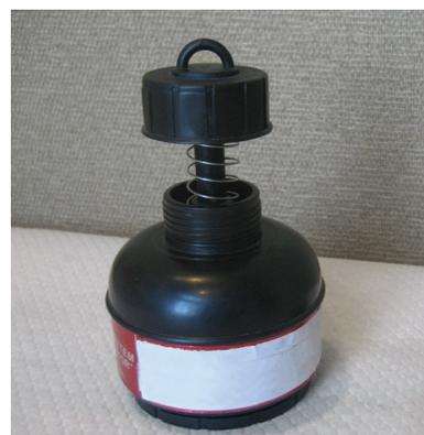
*Figure 2 – Chambre d'ionisation avec électret à long terme*
